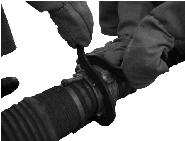
Рисунок 7 – З'єднання всмоктуючих рукавів:
