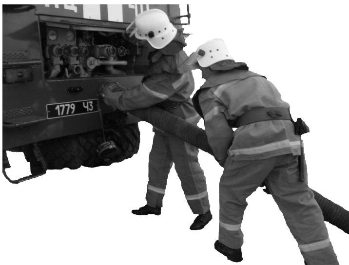
Рисунок 7 – З'єднання всмоктуючих рукавів:
