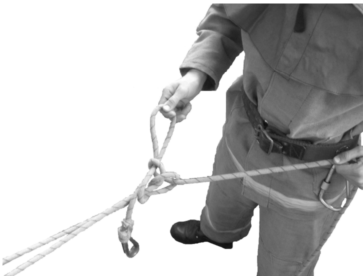
Рисунок 18 (7) – Закріплення рятувальної мотузки за конструкцію другим способом
