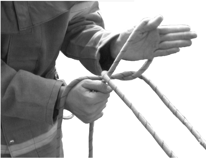
Рисунок 20 (4) – Закріплення рятувальної мотузки за конструкцію четвертим способом:
