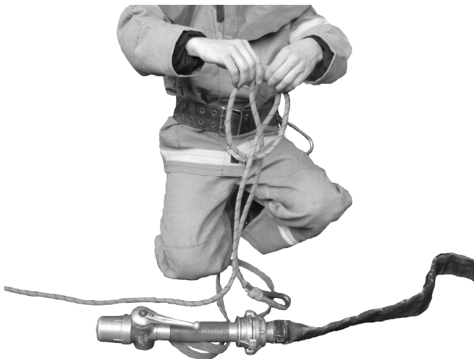
Рисунок 21 (3) – В'язання вузла для підйому ПТО на висоту
