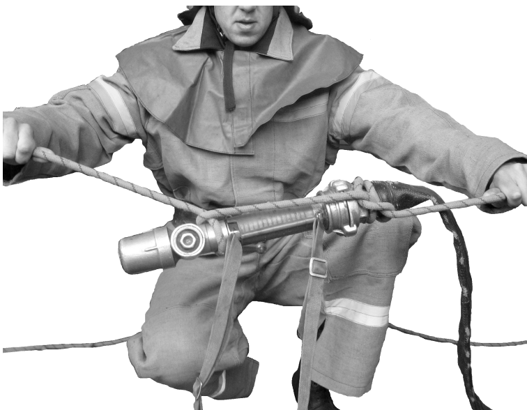
Рисунок 21 (б) – В'язання вузла для підйому ПТО на висоту
