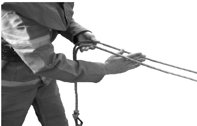
Рисунок 17 (2) – Закріплення рятувальної мотузки за конструкцію першим способом
