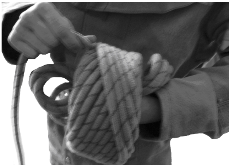
Рисунок 22 (6) – Змотування рятувальної мотузки в клубок
