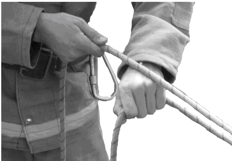
Рисунок 20 (2) – Закріплення рятувальної мотузки за конструкцію четвертим способом
