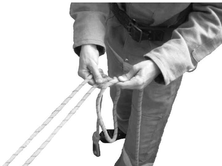
Рисунок 18 (2) – Закріплення рятувальної мотузки за конструкцію другим способом:
