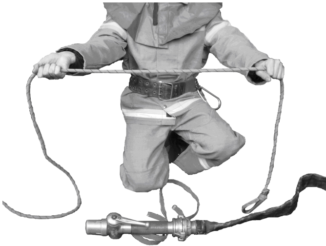
Рисунок 21 (1) – В'язання вузла для підйому ПТО на висоту
