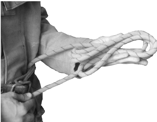
Рисунок 22 (1) – Змотування рятувальної мотузки в клубок
