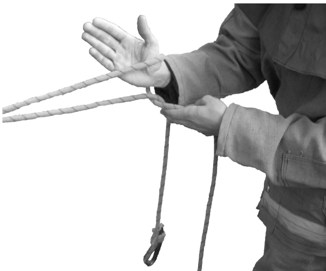
Рисунок 17 (3)– Закріплення рятувальної мотузки за конструкцію першим способом
