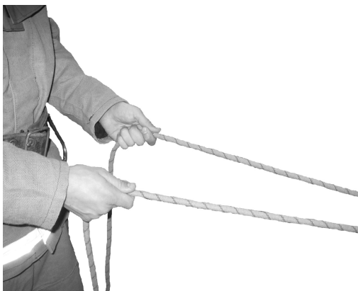
Рисунок 20 (1) – Закріплення рятувальної мотузки за конструкцію четвертим способом
