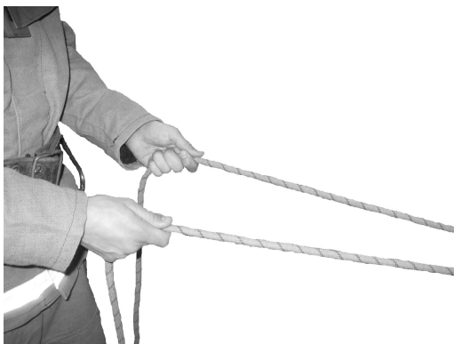
Рисунок 19 (1) – Закріплення рятувальної мотузки за конструкцію третім способом
