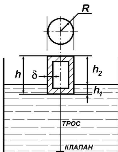
При нормальном уровне воды в резервуаре поплавок плавает свободно, без натяжения троса, который при повышении уровня воды на  $h_2$  достигает подъемной силы открытия клапана  $F_{A2}$ . Таким образом, из (I.14) для выталкивающей (архимедовой) силы  $F_{A2} = \rho g W_2 = \rho g \pi R^2 h_2 = F$  имеем
