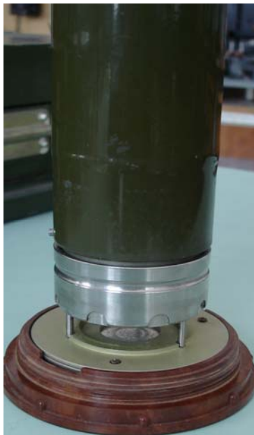
Рис. 4.21. Вимірювання без фільтра ( \beta+\gamma ): 1 – торець БД; 2 – контрольне джерело
