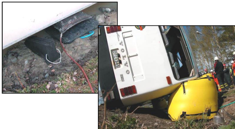
Рис. 4.9.-Схема підйому автобусу пневмо подушками
