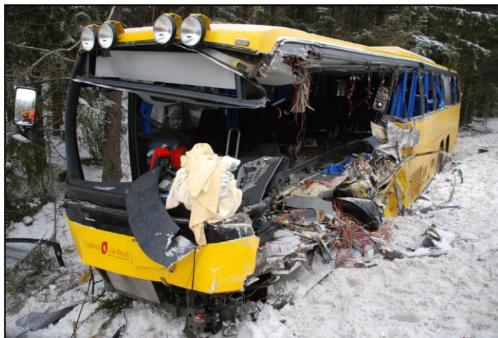
Рис. 4.3-Вид автобусу який після аварії лишився на колесах
