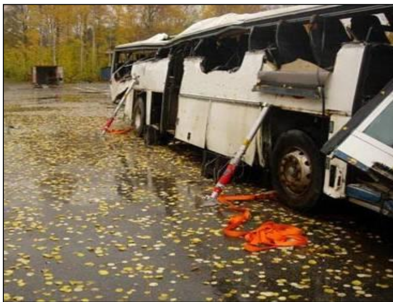
Рис. 4.5-Схема фіксації автобусу на колесах
