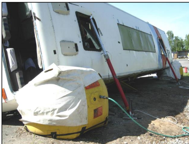
Рис. 4.8.-Схема підйому автобусу за допомогою гідроциліндрів
