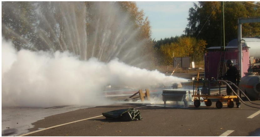
Рис. 2.7.-Постановка водяної завіси на шляху поширення парів аміаку.
