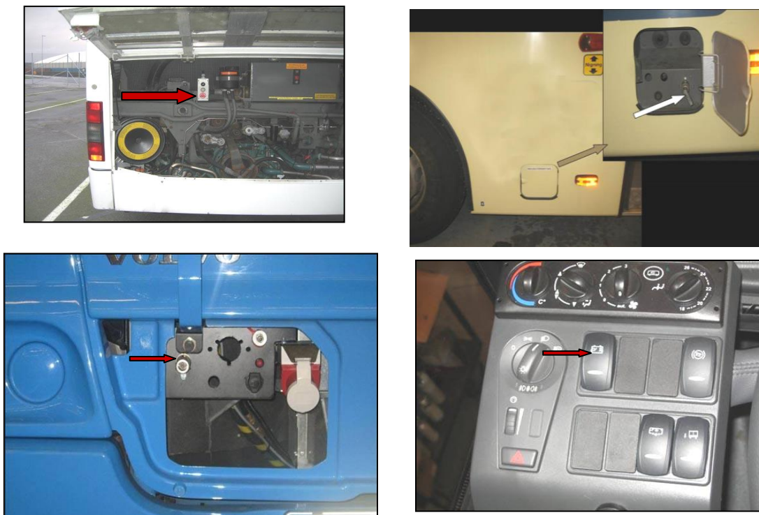
Рис. 4.2- Місця аварійного відключення двигуна автобусу
