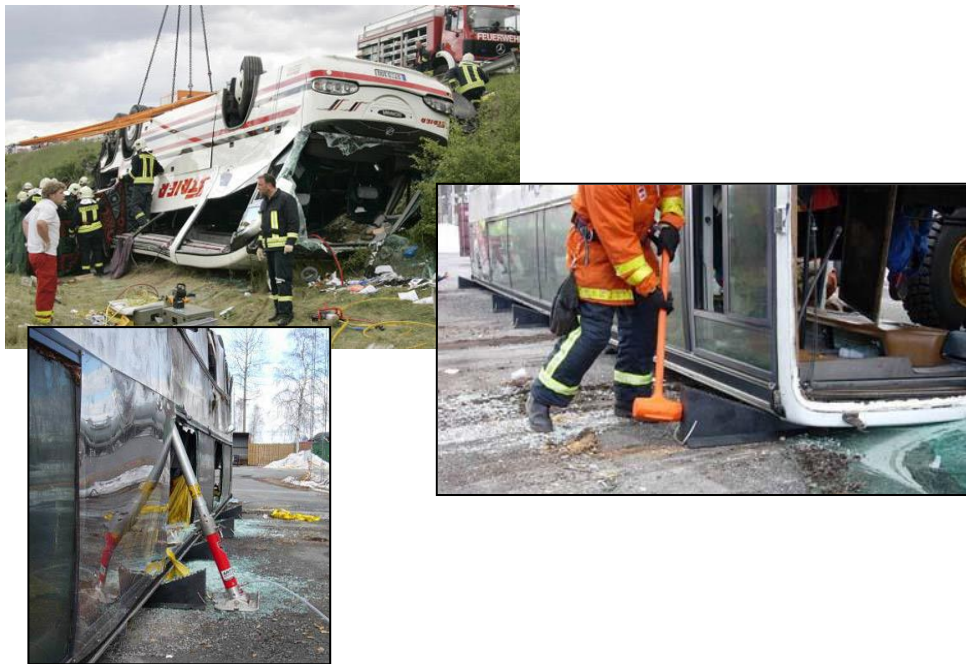
Рис. 4.6-Схема фіксації автобусу на даху
