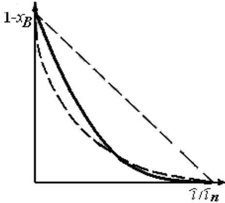
Рис. 5.6 – Зависимость доли превращенного твердого реагента от времени пребывания твердой частицы в реакторе при лимитировании процесса внешней диффузией (штриховая линия), поверхностной химической реакцией (сплошная); внутренней диффузией (штрихпунктирная)
