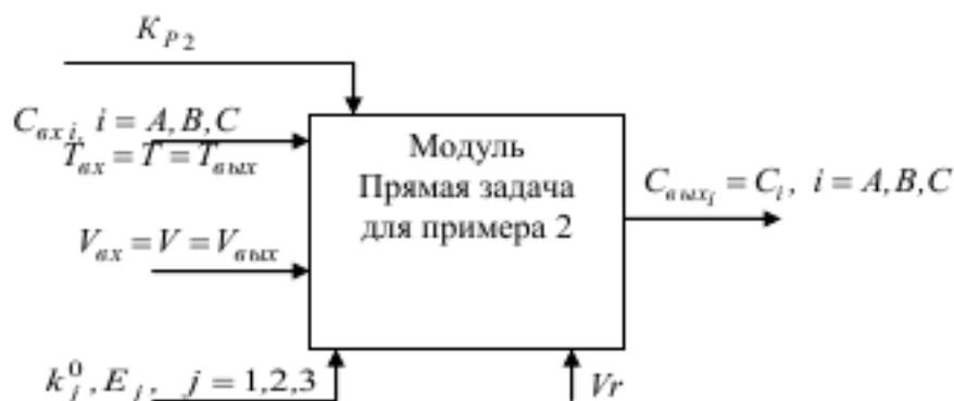
Рис. 6.4 – Расчетный модуль компьютерного решения прямой задачи для примера 2
