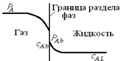
Рис. 5.7 – Распределение парциального давления и концентрации растворимого газообразного вещества  $A$  в фазах при массопередаче
