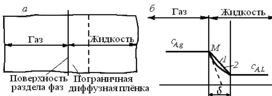
Рис. 5.8 – Схема пленочной модели (а) и профиль изменения концентрации растворяемого компонента  $A$  (б): 1, 2 – соответственно при отсутствии и наличии химической реакции
