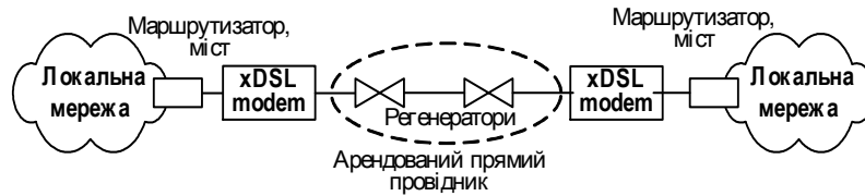
Рис. 2.18 – Застосування технологій xDSL для об'єднання локальних мереж
