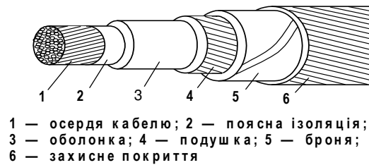
Рис. 5.11 – Загальний вигляд кабелю з захисними покриттями
