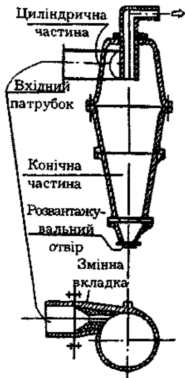
Рисунок 9.6 – Відкритий гідроциклон
