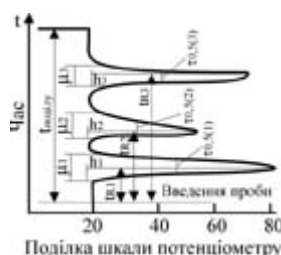
Рис. 2.77 – Хроматограма поділу суміші трьох компонентів
