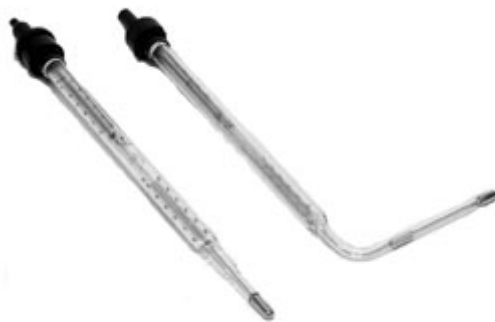
Рис. 2.2 – Технічні скляні електроконтактні термометри: а – прямий; б – кутовий
