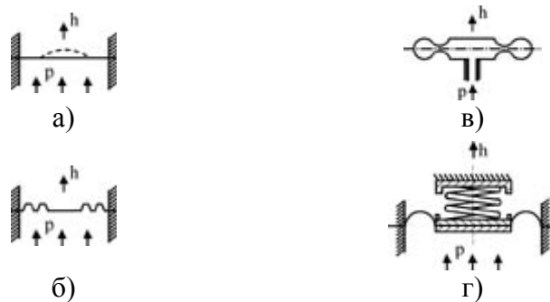
Рис. 2.45 – Мембранні чутливі елементи: а), б) плоскі і гофровані мембрани; в) мембранні коробки; г) м'які мембрани з жорстким центром
