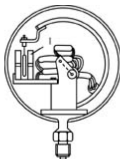
Рис. 2.39 – Схема манометра МЕД із диференційно-трансформаторним перетворювачем
