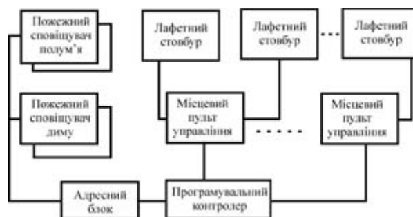
Рис. 1.7 – Структурна схема локальної системи роботизованих засобів пожежогасіння
