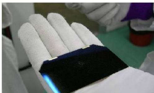
Рисунок 6.3 – Арсенід-галієві ФЕП (GaAs)
