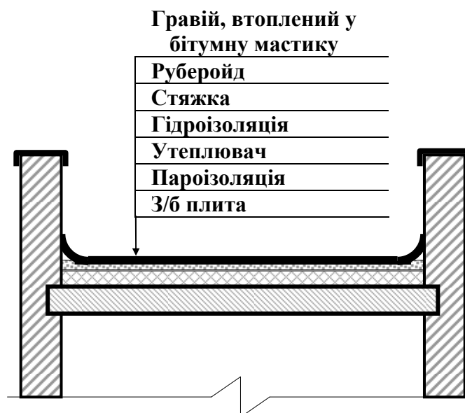
Рисунок 3.25 - Схема суміщеного покриття, що не вентилюється
