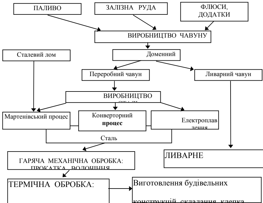
Рисунок 4.2 – Схема виробництва чорних металів та будівельних матеріалів з них
