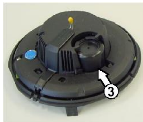
Рисунок 3. Розміщення чутливих елементів сповіщувача: 3 – датчик чадного газу.
