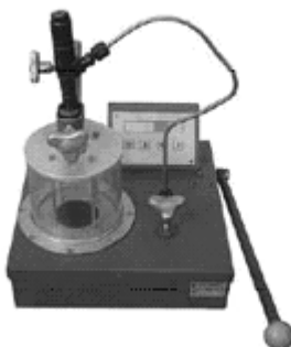
Рис. 4.4 Стенд для випробування і регулювання дизельних форсунок з електронною вимірювальною системою М-106 Е
