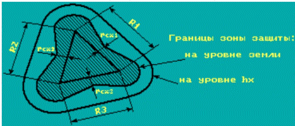
Рис. 10. Зона защиты (в плане) многократного стержневого молниеотвода.
