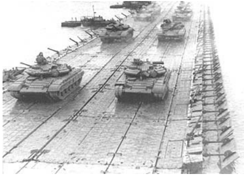
Рис. 2.31. Фрагмент понтонного мосту, що наведений за допомогою парку ППС-84
