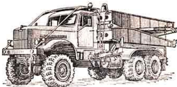
Рис. 2.48. Важкий механізований міст ТММ
