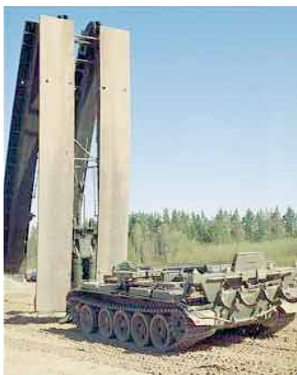
Рис. 2.60. Наведення мосту за допомогою МТ-55
