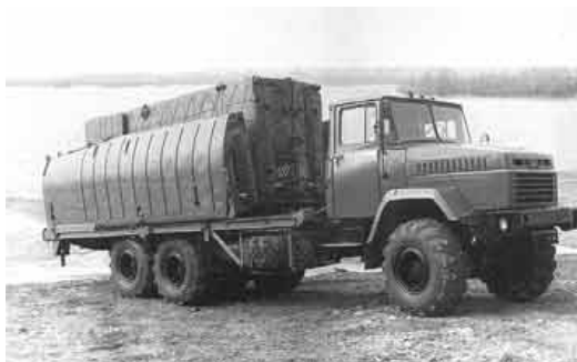
Рис. 2.33. Автомобіль з береговою ланкою
