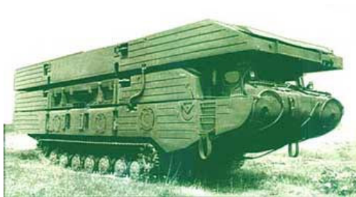
Рис. 2.24. Понтонно-мостова машина ПММ-2
