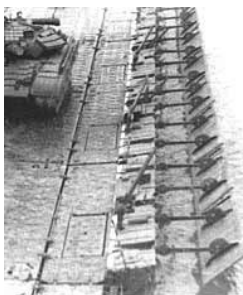
Рис. 2.30. Фрагмент понтонного мосту, що наведений з допомогою парку ПМП-М
