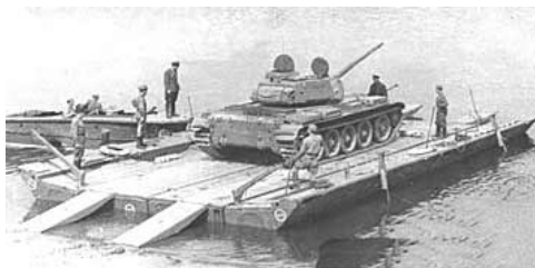
Рис. 2.26. 40-тонний пором з вантажем
