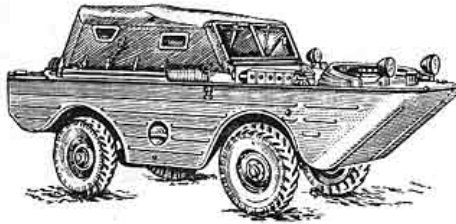
Рис. 2.13. Малий плаваючий автомобіль-амфібія МАВ
