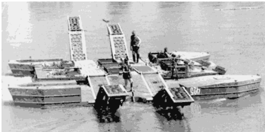
Рис. 2.21. Пором без вантажу (добре видні в'їзні апарелі)
