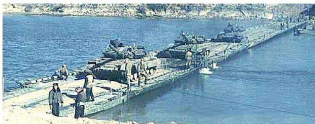
Рис. 2.39. Понтонно-мостовий парк ПП-91
