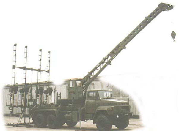
Рис. 2.50. Установка будівництва мостів УСМ
