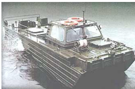
Рис. 2.43. Буксирно-моторний катер БМК-225
