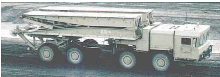
Рис. 2.54. Важкий механізований міст ТММ-6
