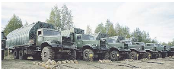
Рис. 2.25. Понтонно-мостовий парк ПМП-М
