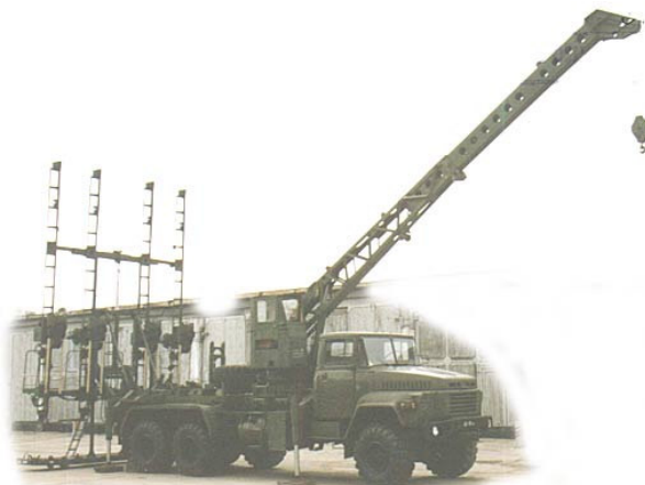
Рис. 2.50. Установка будівництва мостів УСМ
