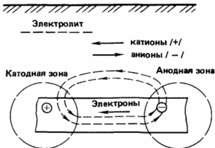
Рис. 6.1 Процес електрохімічної корозії
